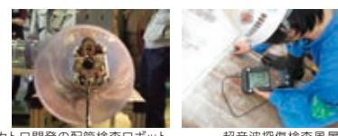
メカトロ開発の配管検査ロボット 超音波探傷検査風景
