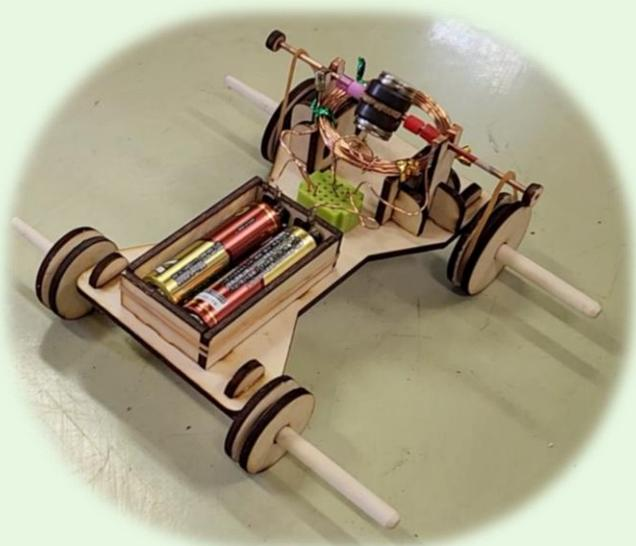
北九州高専製の教材キットを用いてモータ・コイル・車体を組み上げ、電・磁・力による電気エネルギーから運動エネルギーの変換について実験を通して学びます！
