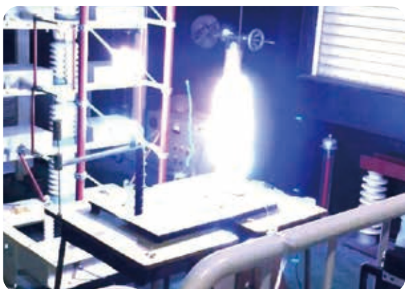
300kV高電圧試験装置による絶縁破壊試験 (Dielectric breakdown test by 300kV high voltage testing System)
